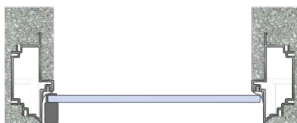
Rys. 2 – DRZWI ZLICOWANE ZE ŚCIANĄ, OTWIERANE NA ZEWNĄTRZ
