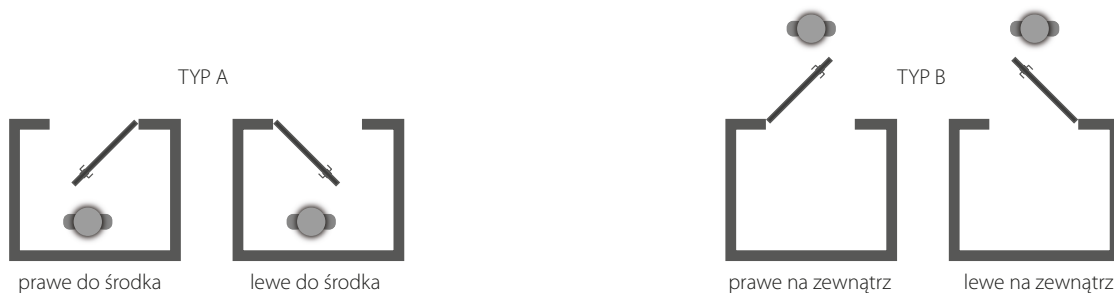
Rys. 5 – SCHEMAT OKREŚLANIA KIERUNKÓW OTWIERANIA DRZWI DLA OŚCIEŻNIC ZEROMUR TYP A I TYP B
